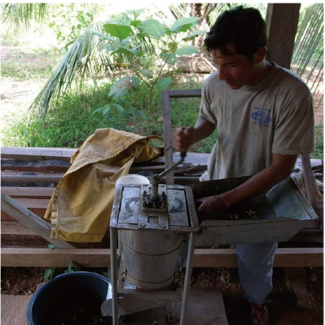
インフラが未整備の村落に導入した手動莢剥き機。
